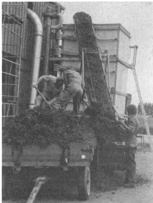
Fig. 7. Der fyldes gødning på komposteringsvarmeanlægget. I praksis er transportøren direkte tilsluttet udmagningsanlægget.
