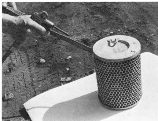
Fig. 10. Hold afstand ved blæsning med trykluft.
