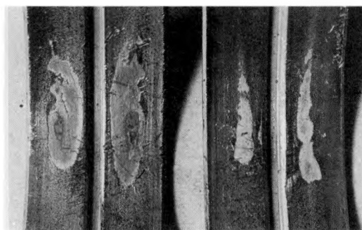
Fig. 12. Ødelagt hovedleje fra traktor. Lejet er brændt sammen som følge af manglende smøring (for stiv olie) i vinteren 1981/82.
