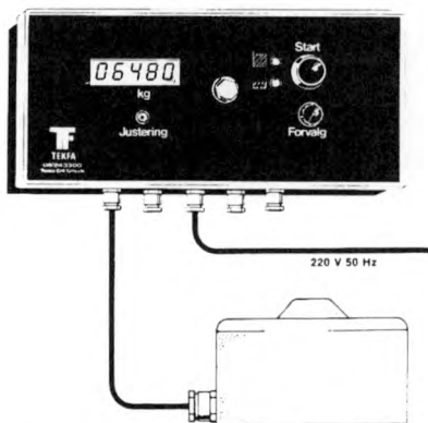
Fig. 4. Vejecelle og vægtindikator samt monteringsdetalje for vejecelle. Det viste udstyr kan monteres til vejning af fodersiloer, og til foderblandingsanlæg.
