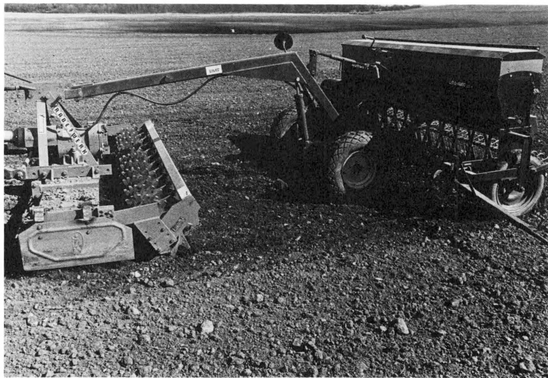
Har traktoren ikke tilstrækkelig løftekapacitet, vil bugservognen være til stor nytte.
