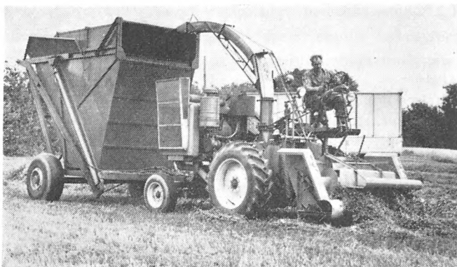
Fig. 1. En stor, selvkørende grønthøster og grøntsnitter i arbejde med 135 HK dieselmotor.
