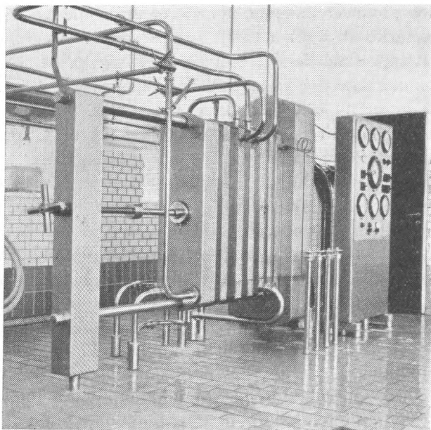
Fig. 4. Skummesal med et stassanoanlæg, der kan behandle 4500 l mælk i timen. (Aabenraa centralmejeri).
