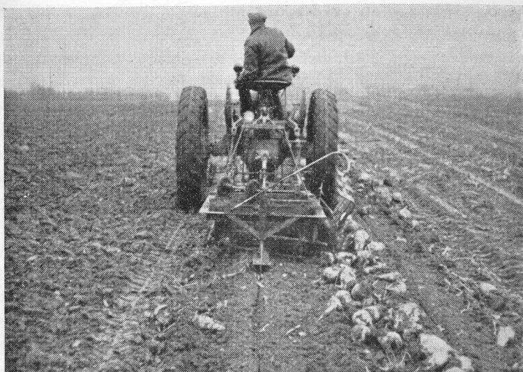
Fig. 7. Forsøgsmodel af en hydraulisk ophængt roeoptager, hvor 4 rækker roer samles i een streng ved hjælp af en roterende samletromle.
