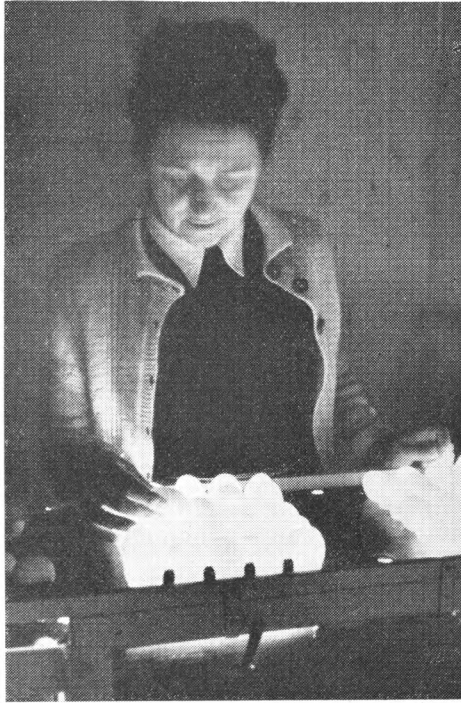
Fig. 2. Billedet viser æggene på pakkeriets transportbånd, idet de passerer lyskassen, hvor der ved hjælp af gennemlysning sker en kvalitetssortering.
