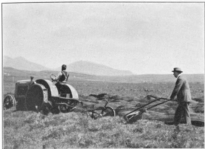
Fig. 13. Nyopdyrkning. Der pløjes med enfuret 20" Plov og Traktor.
