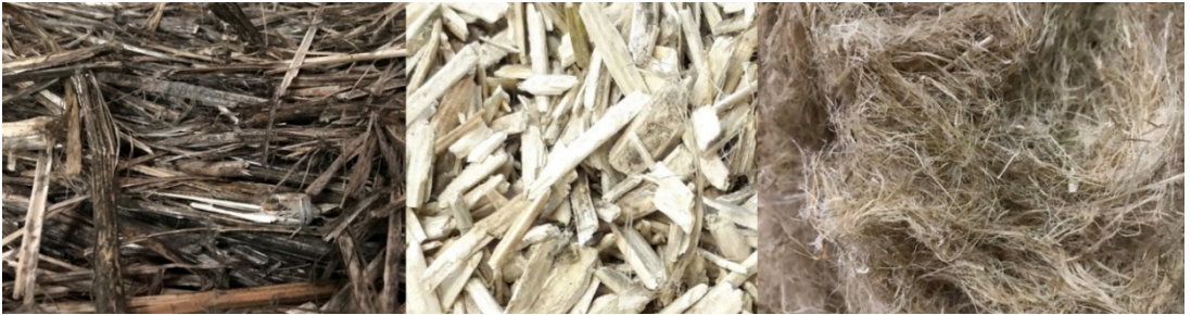
Figur 3: Hampestængler presset i baller (til venstre) forarbejdes til hampeskæver (i midten) og -fibre (til højre). Her er hamp fra Bio2Products forarbejdet ved DunAgro, Holland. Kreditering: Forfatteren.
