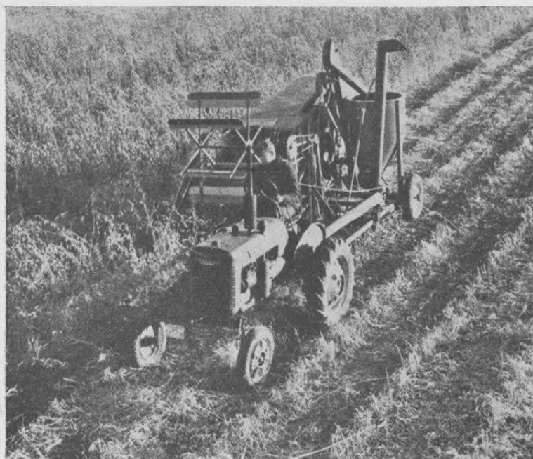
Fig. 7. Amerikansk 3 \frac{1}{2} Fod Mejetærsker, der trækkes af 19 HK Traktor. (Efter The Farmall System).
