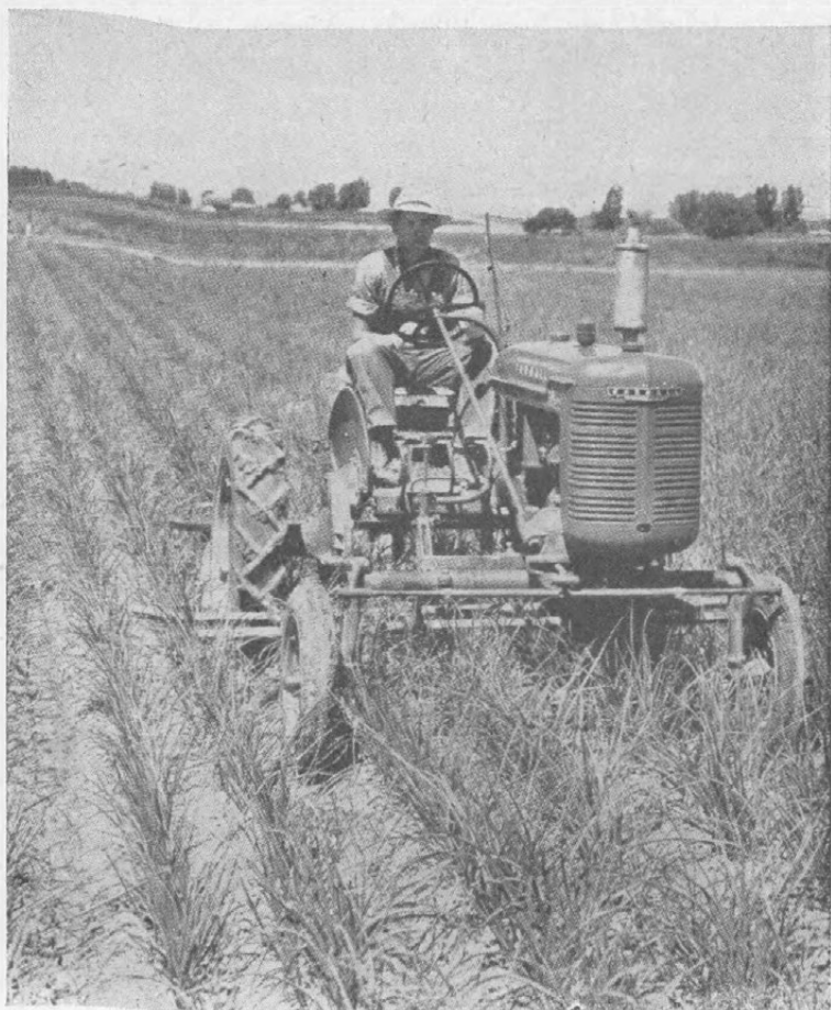
Fig. 6. Let amerikansk Traktortype, 19 HK, ved Radrensning. (Efter The Farmall System).
