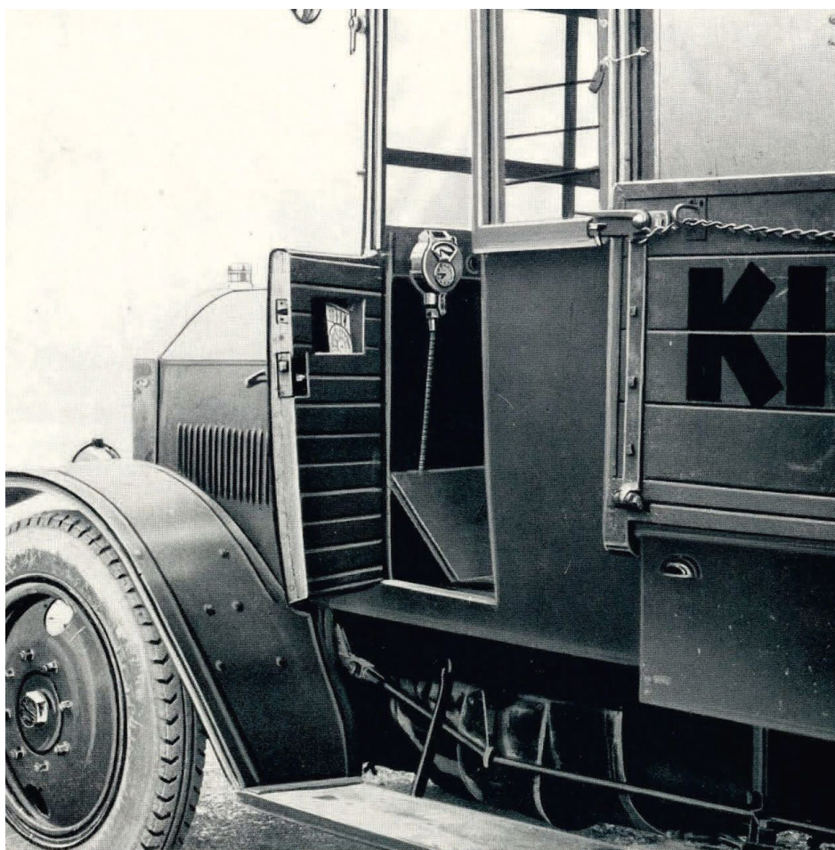
Fartskrivers blev i mange år brugt som ekstraudstyr af vognmænd, der ønskede dokumentation for deres kørsler (Continental, 2023).
