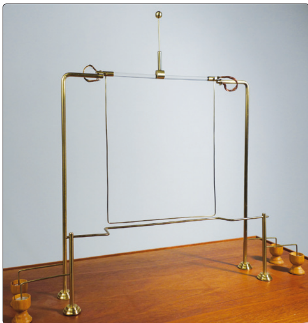
I Steno Museets samling findes der en rekonstruktion af det apparat, som Ampère udviklede i 1820 for at vise, at to strømførende ledninger påvirker hinanden ligesom to magneter. Den ene leder sidder fast, mens den anden udgør en fint afbalanceret gynges, som kan give et stort udslag selv ved en ret lille strømstyrke. Foto: Hans Buhl.
