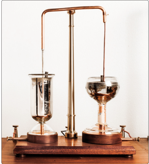
Steno Museets samling rummer også en rekonstruktion af Faradays rotationsapparat fra 1821. Til venstre bevæger magneten i glasset med kviksølv sig rundt om ledningen, når der løber strøm igennem den. Til højre er det ledningen, der bevæger sig. Rotationsapparatet var verdens første elektromotor. Foto: Lise Balsby, AU Foto.
