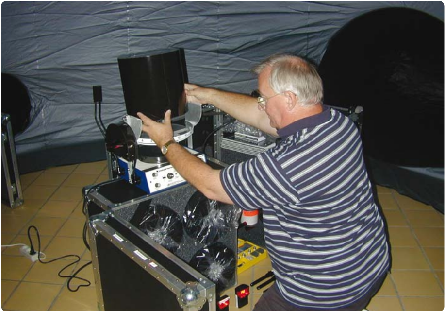
En StarLab cylinder sættes på plads på projektoren. Cylinderne er af kraftigt plastic. Af de mere end 30 forskellige er 12 anskaffet til Grønland. (Foto: Ole J. Knudsen)
