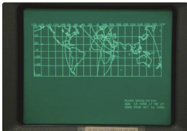
Vektorgrafikskærme var rigtigt gode til at lave stregtegninger. Der kan ses en video af optegningen på www.pdp8.net/tek4010/pluto.avi . Foto: David Gesswein, CC BY-SA 4.0.
