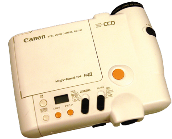
I 1988 lancerede Canon dette "still video camera", som blev et skridt på vejen til det digitale kamera. Det var et elektronisk fotoapparat, der gemte faste billeder som analoge signaler på en magnetisk videodisk. Foto: Mary Marie Kromann.
