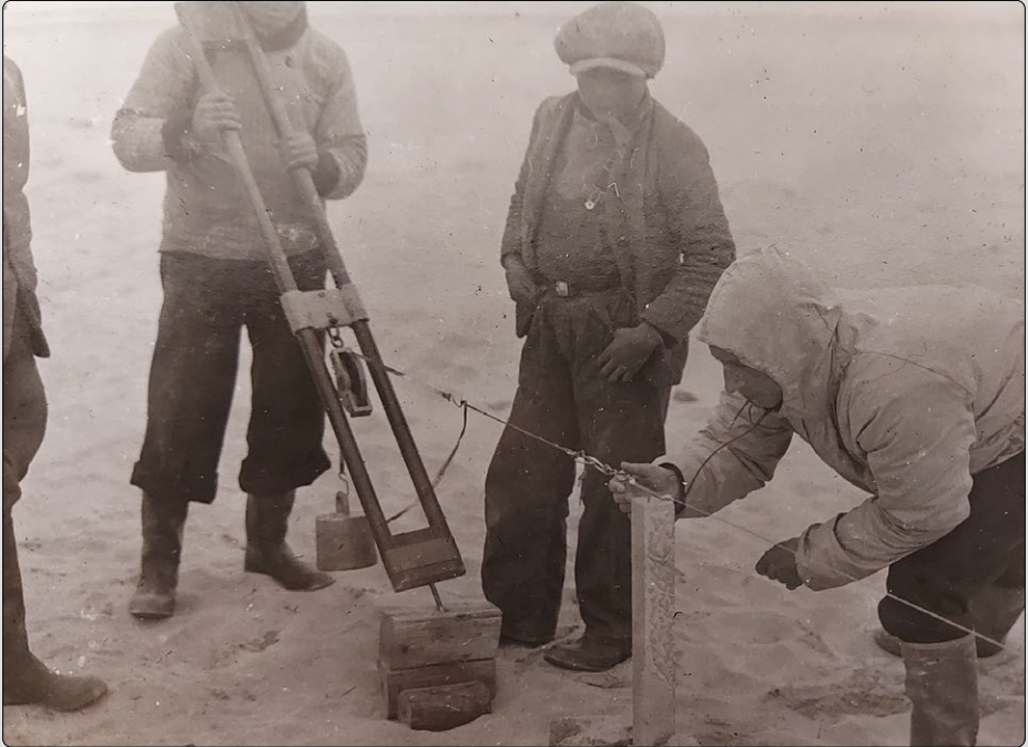
Når man skulle måle med basistråden, blev den spændt ud med et 10 kg lod i begge ender. Aftællingen skete på et særlige skalastykke. Foto: Geodætisk Institut/Styrelsen for Dataforsyning og Infrastruktur.
