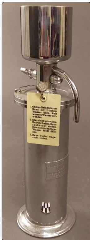
Radium Emanator, Type T fra Allgemeine Radium Akt. Ges., Berlin. Ca. 1930. På den vedhængte brugsanvisning står der: "1. Fyld den øverste beholder op til randen med friskt vand. Brug ikke varmt vand. 2. Hold glasset direkte under tuden. Drej hanen lodret. Det radonholdige vand vil derefter løbe ud. 3. Drej hanen tilbage til lodret position." Foto: Steno Museet.
