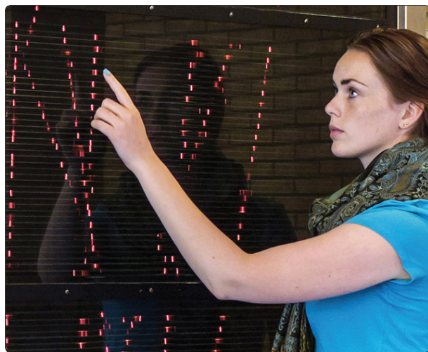
I et gnistkammer kan man bl.a. se spor efter myoner fra den kosmiske stråling. Forhåbentlig bliver det en dag muligt at udstille det gnistkammer, der findes i Steno Museets magasin. Foto: J. Koopstra, Wikipedia, CC BY-SA 4.0.
