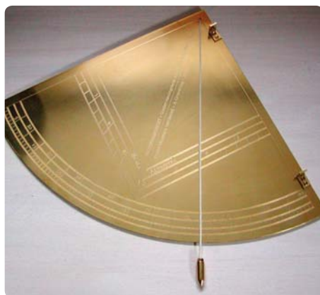
Nationalmuseets originale kvadrant fra 1547 – på forsiden af et lille hæfte til undervisningsbrug og den færdige kopi med sigter og lodsno. (Foto: tv. stillet til rådighed af Nationalmuseet, th: Ivan Tafteberg Jakobsen)
