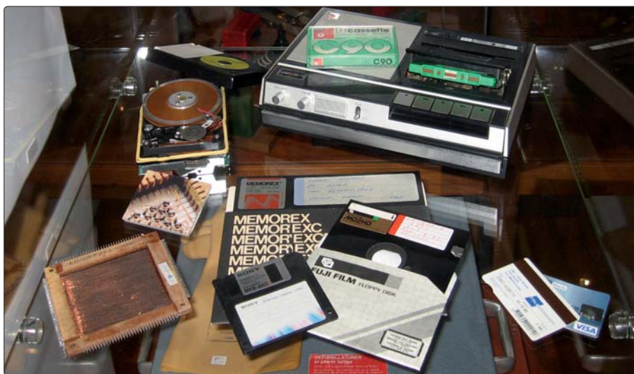
Selvom floppydiske, kassettebånd og kreditkort ser meget forskellige ud, er de alle eksempler på magnetisk lagring. Ferritkernelageret nederst til venstre benytter også dette fysiske princip. (Foto: Hans Buhl)
