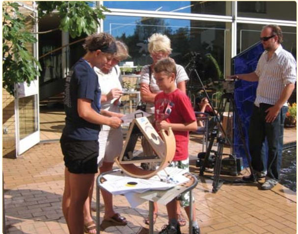
En "Sunspotter" viser en projektion af solskiven på et stykke papir. (Foto: Hanne Teglhus)
