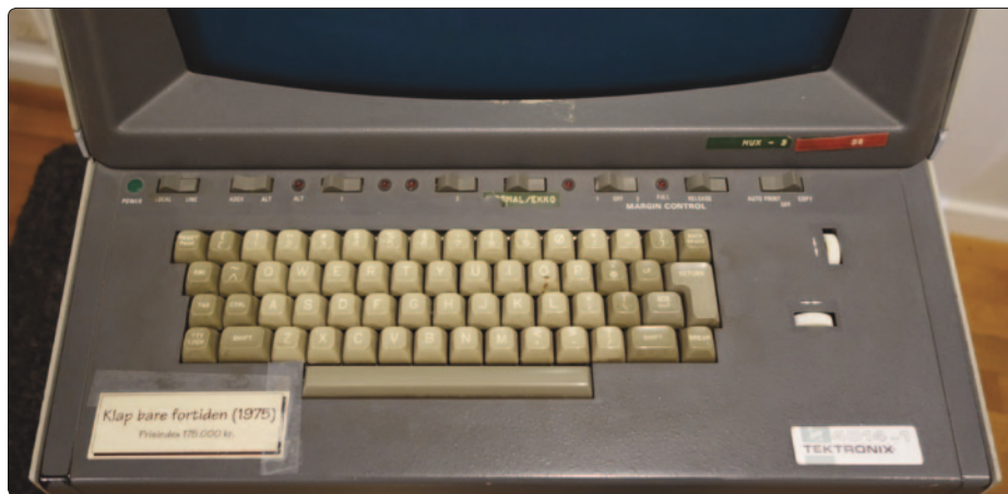
Tektronix 4014-1 skærmen har et indbygget keyboard med 60 taster samt en række kontrollkontakter. De to fingerhjul til højre var til at flytte cursoren med. Foto: Hans Buhl.
