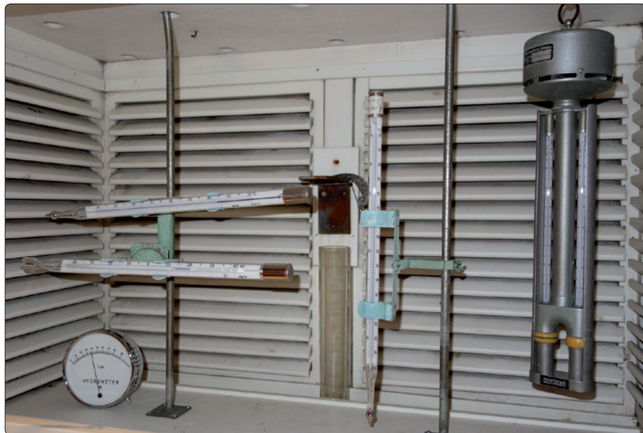
Den engelske hytte, som Steno Museet har fået, rummer i venstre side et maksimumstermometer, et minimumstermometer og nederst et hårhygrometer. I midten ses det lodrette stationstermometer, og til højre hænger et psykrometer, som måler luftfugtigheden ud fra temperaturforskellen mellem et alm. termometer og et termometer, hvis kviksølvbeholder er omviklet med et konstant fugtet stykke tøj eller papir. Foto: Hans Buhl.
