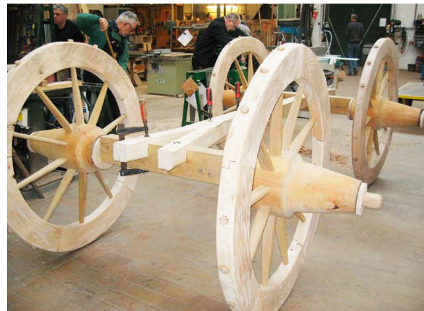
På den Slesvigske Vognsamling arbejder man med rekonstruktionen af en middelaldervogn (fruervogn). Her ses den rekonstruerede underdel. Foto: Museum Sønderjylland – Slesvigske Vognsamling.
