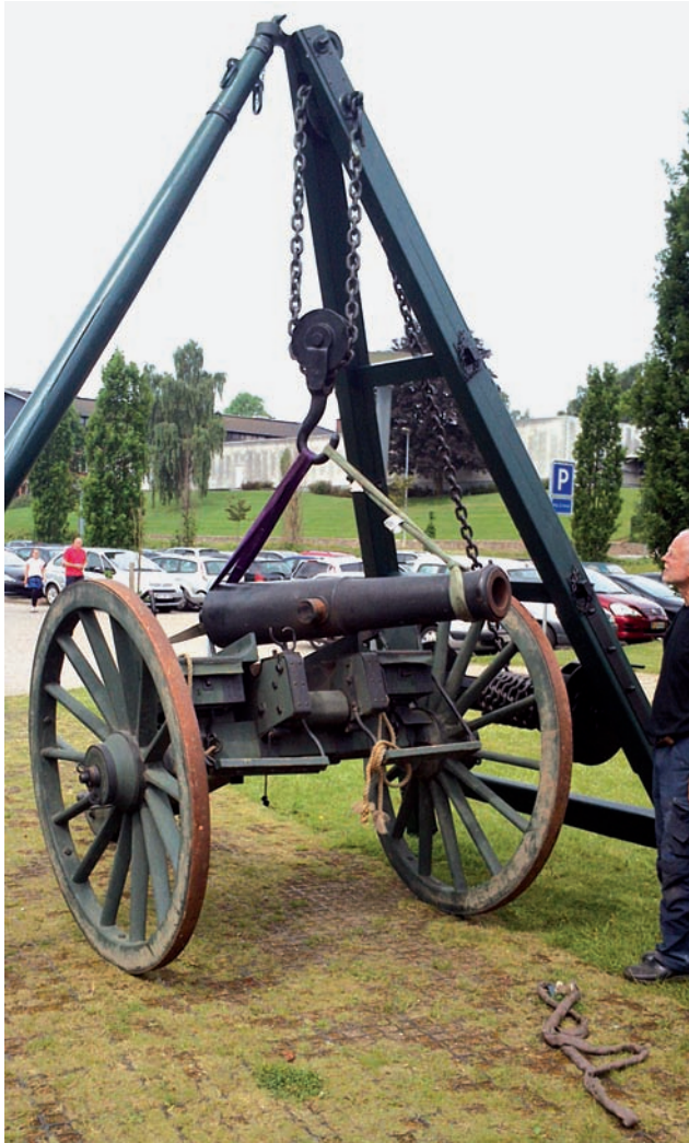
Slesvigske Vognsamlings værksted har til Historiecenter Dybbøl Banke efter originale tegninger og i original størrelse udført en rekonstruktion af en stor løftekran, der skal anvendes til at løfte de tunge kanonrør fra laetterne. Foto: Museum Sønderjylland.
