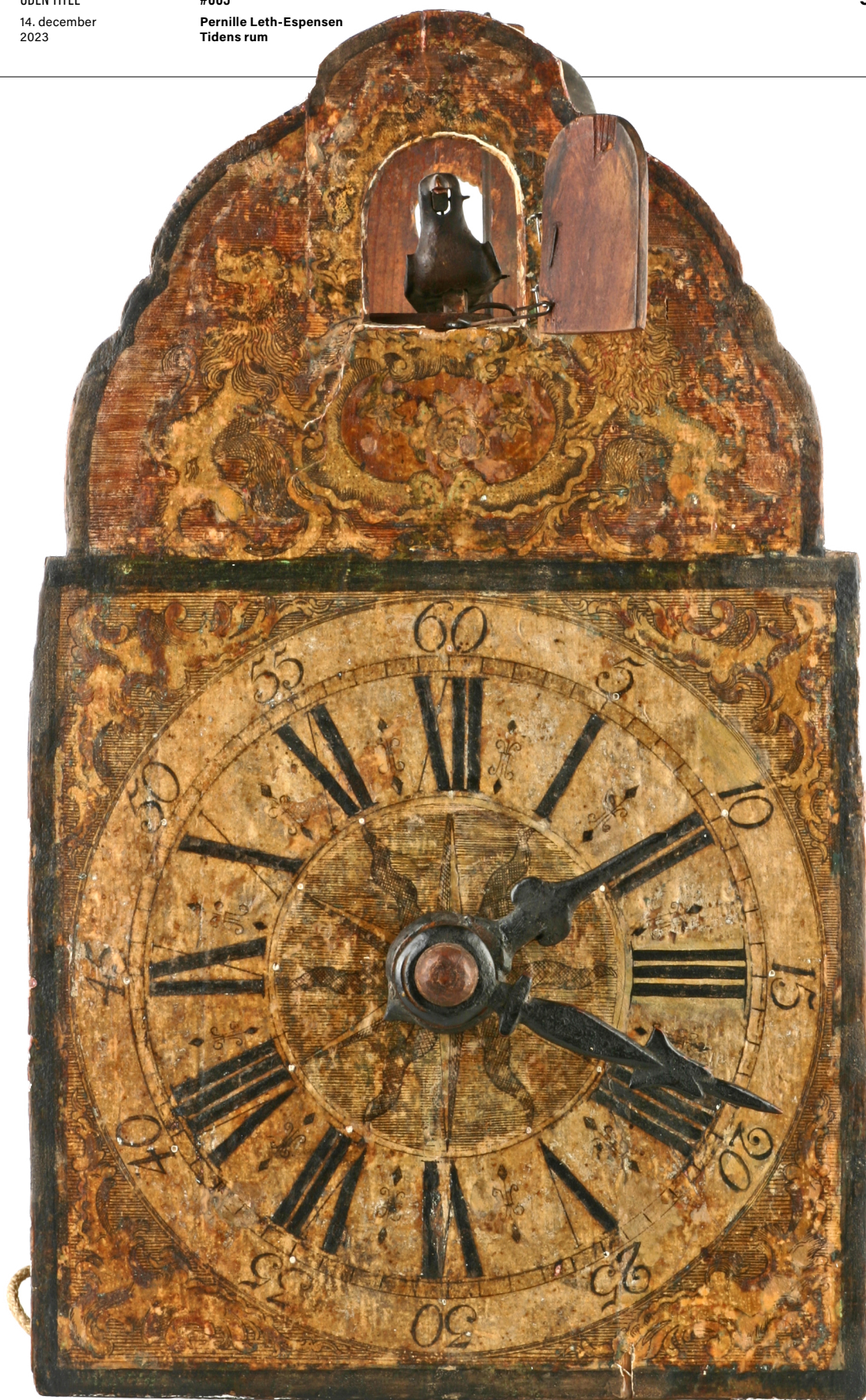
Ill. 14 — Johannes Wildi, Eisenbach, ca.1780-90. Det ældste kendte kukur, der er signeret af dets skaber, Deutsches Uhrenmuseum, Furtwangen. Front af træ med påsat papir og tandhjul i træ © Deutsches Uhrenmuseum.
