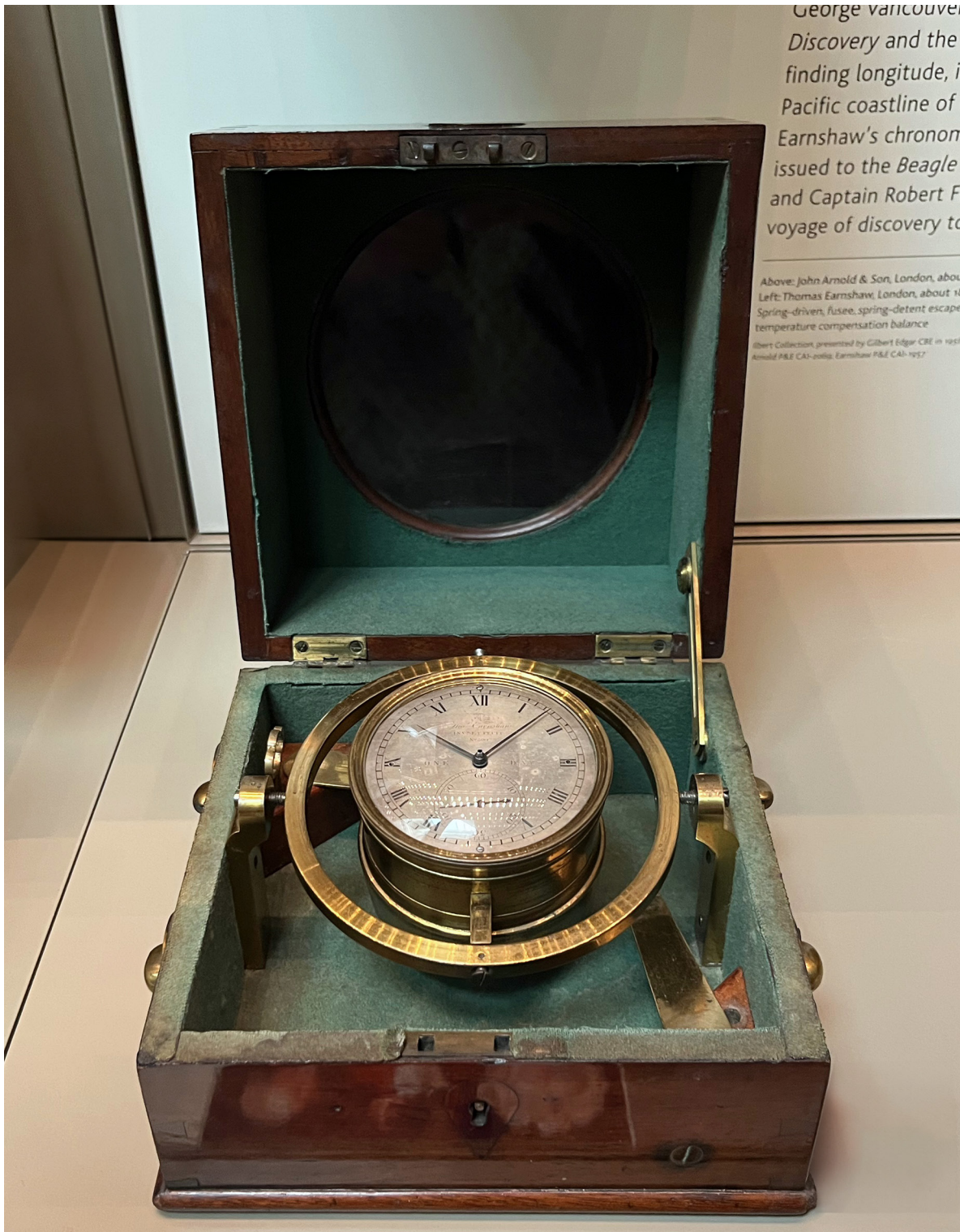
ILL. 24 — Thomas Earnshaw, London, ca. 1800. British Museum . Fjederur, fusee, spring-detent escapement, temperaturkompenseret balance. Den var ombord på skibet HMS Beagle 's anden rejse i 1831-1836, hvor Charles Darwin også var passager. Foto: Pernille Leth-Espensen.
