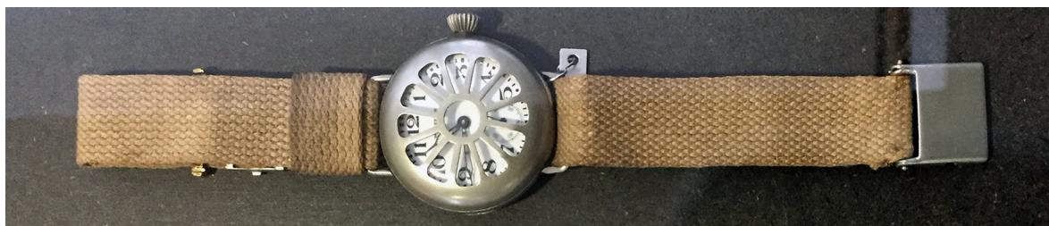
ILL. 17 — Armbåndsur med beskyttelsesgitter, et såkaldt "skyttegravsur". Waltham A. W.W. co., 1921, Deutsches Uhrenmuseum . Foto: Pernille Leth-Espensen.
