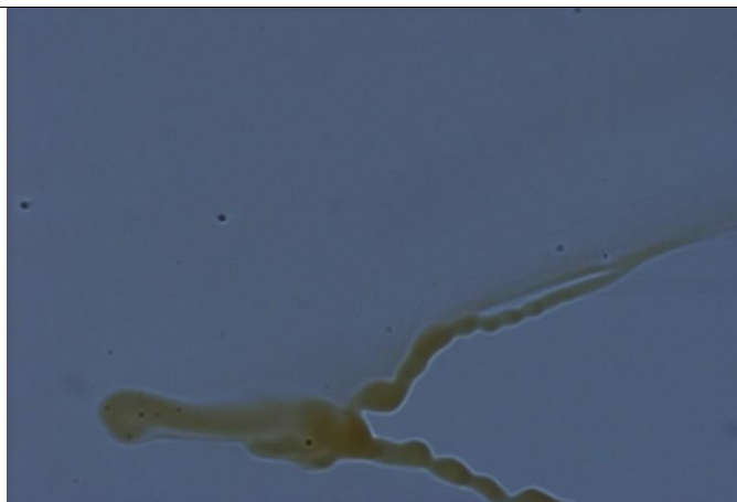
Figur 12 Polariserede lys ved 10X optisk zoom af vores tyndfilm (5 mg/ml)
