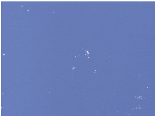
Figur 19 Midten af prøven 1, epipolariseret ved 90°, 10x. Lysdiffraktion ved 90 graders polarisering; de lyser pletter er uopløste .
