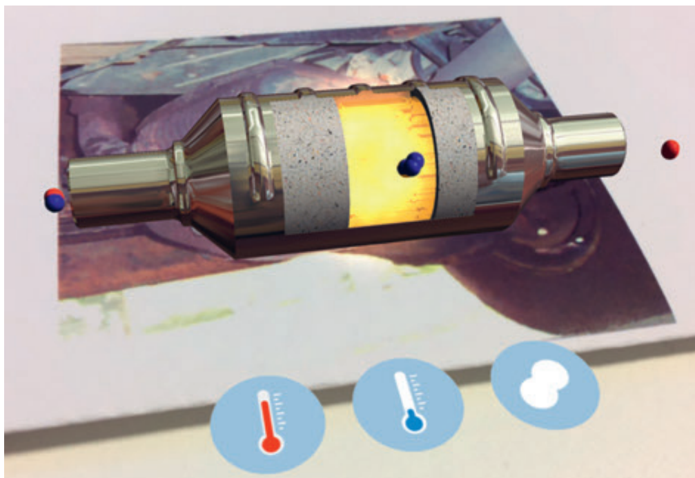
Figur 2. Figuren viser et skærmbillede fra “Catalytic converter” med en digital 3-d-model af en katalysator. Stofomdannelsen er vist på mikroniveau. Den konkrete markør er en visuel repræsentation af en katalysator som den ser ud i virkeligheden. I perspektivering nedenfor følger overvejelser om at placere markøren på en fysisk model af en bil.
