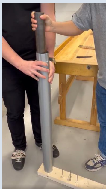
Figur 3. Elever hamrer søm i træ vha. et rør og et lod.
