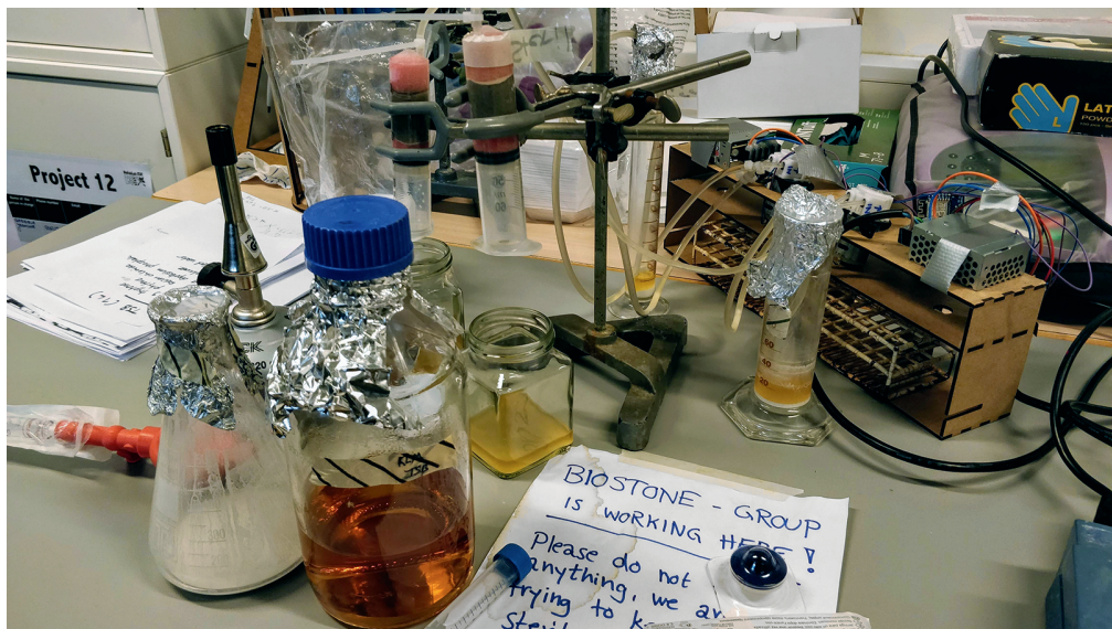
Illustration 2. Biostenforsøgsopstillingen. Laboratorieglass, engangssprøjter, syltetøjsglas og hjemmebygget elektronik.
