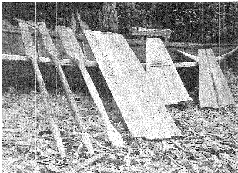
Bild 6. Båtens tillbehör, fr. v. roddåror, styråra, mittskotten och stävskottarna.
