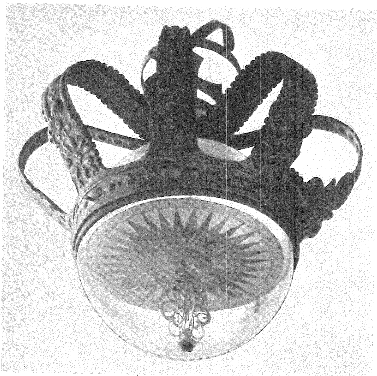
Kronekompass i kardansk ophængning, fremstillet i 1700'ernes sidste halvdel af Iver Jensen Borger, København. Den kolorerede kobberstukne rose hviler på en meget smuk messingpivot.
