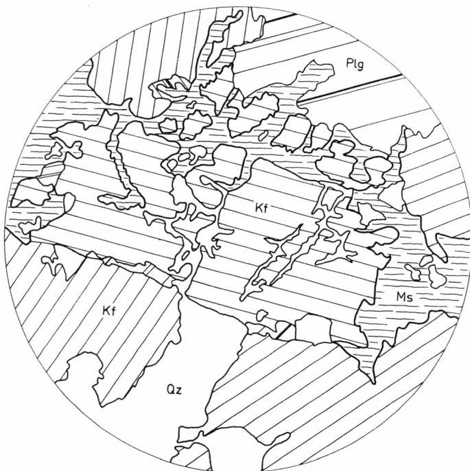
Fig. 24. Retikulares Gefüge von Quarz und Muskowit in Kalifeldspat (St 267).]
