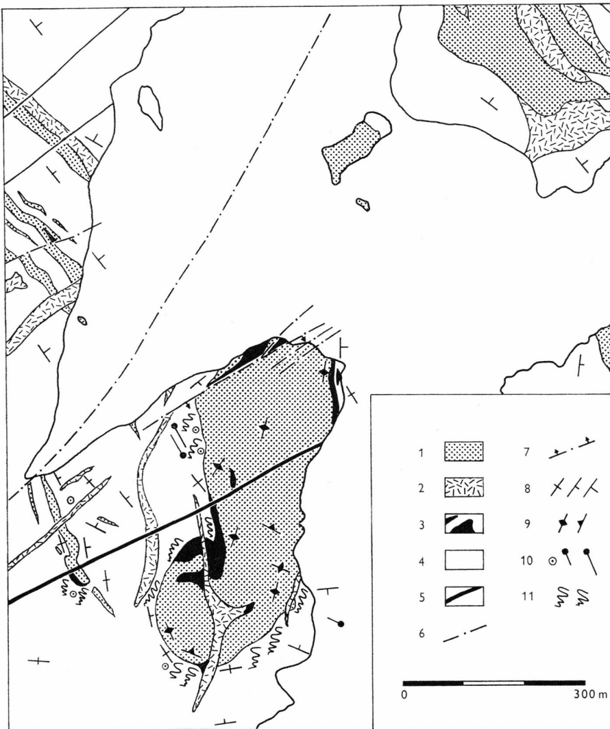
Fig. 15: Carte schématique, d'après les travaux de terrain, d'une partie des ultramafites (sills, lentilles et massifs) de la région du lac 510. (Siksaksø).
