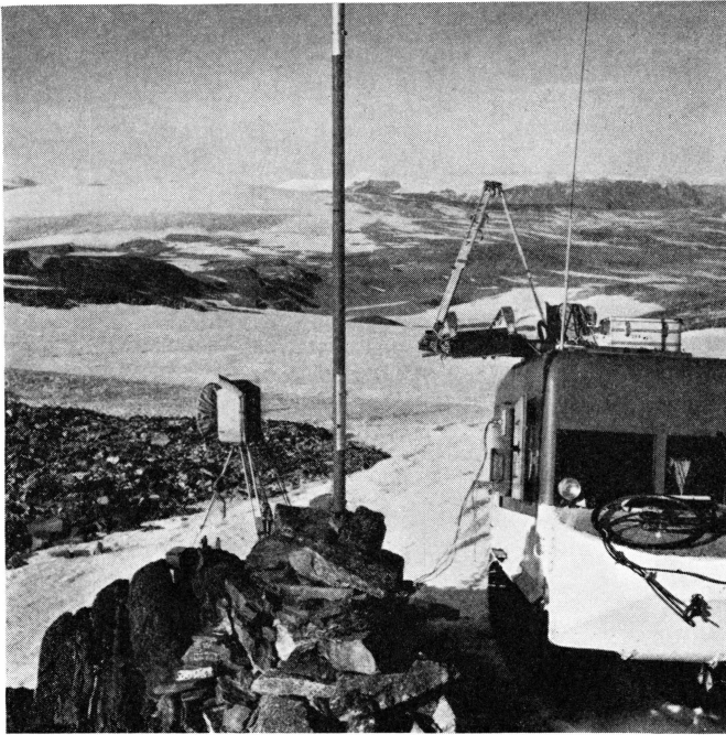
Bild III. Basisendpunkt Cecilia Nunatak Süd; Steinmann mit Pegelrohr, Tellurometer in Meßstellung gegen Cecilia Nunatak Nord über Bolzen.
