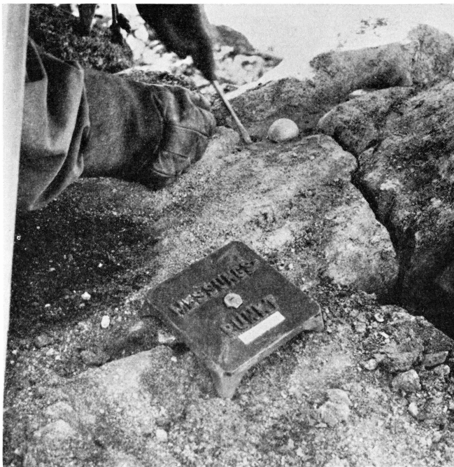
Bild IV. Basisendpunkt Cecilia Nunatak Süd; Bolzen und Platte.
