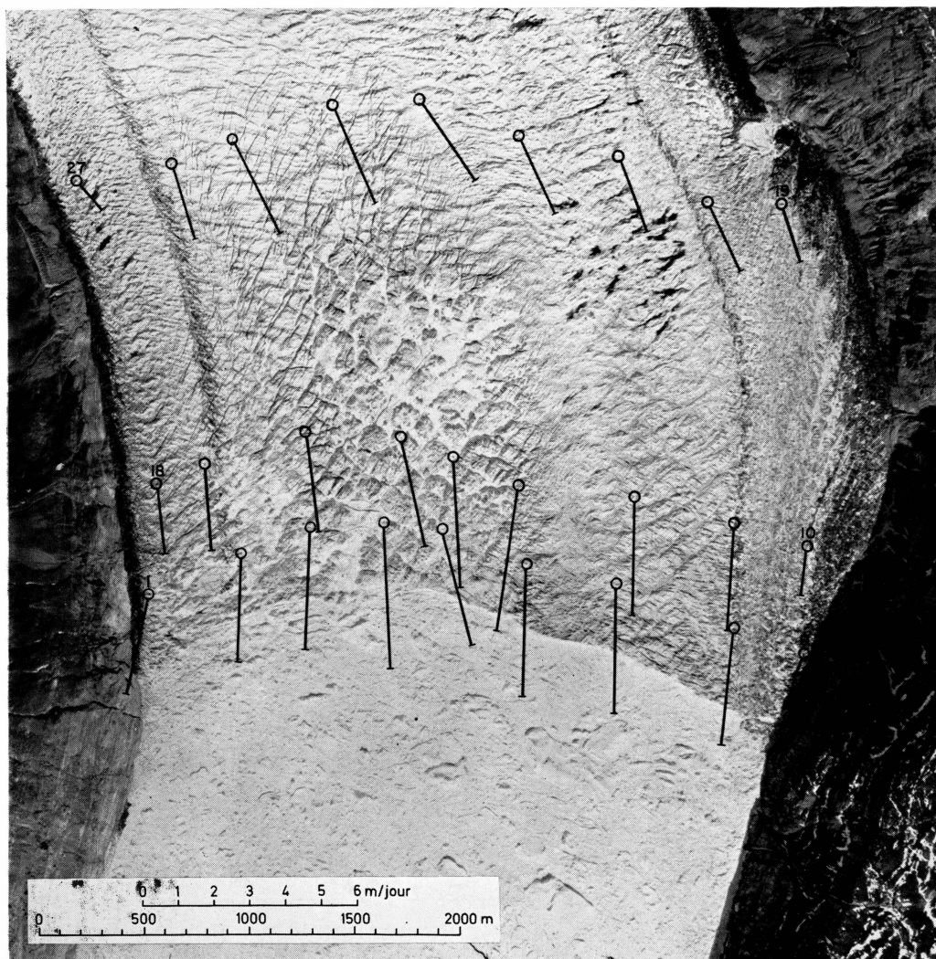
Fig. 32. Umiámåko Isbræ. Vitesses superficielles (échelle des vitesses: 0-6 m/jour). Prises de vues Institut de Géodésie Copenhague. Missions photographiques 272/Q, 9-6-64 et 273/Q, 22-6-64. Mesures photogrammétriques Institut Géographique National Paris.
