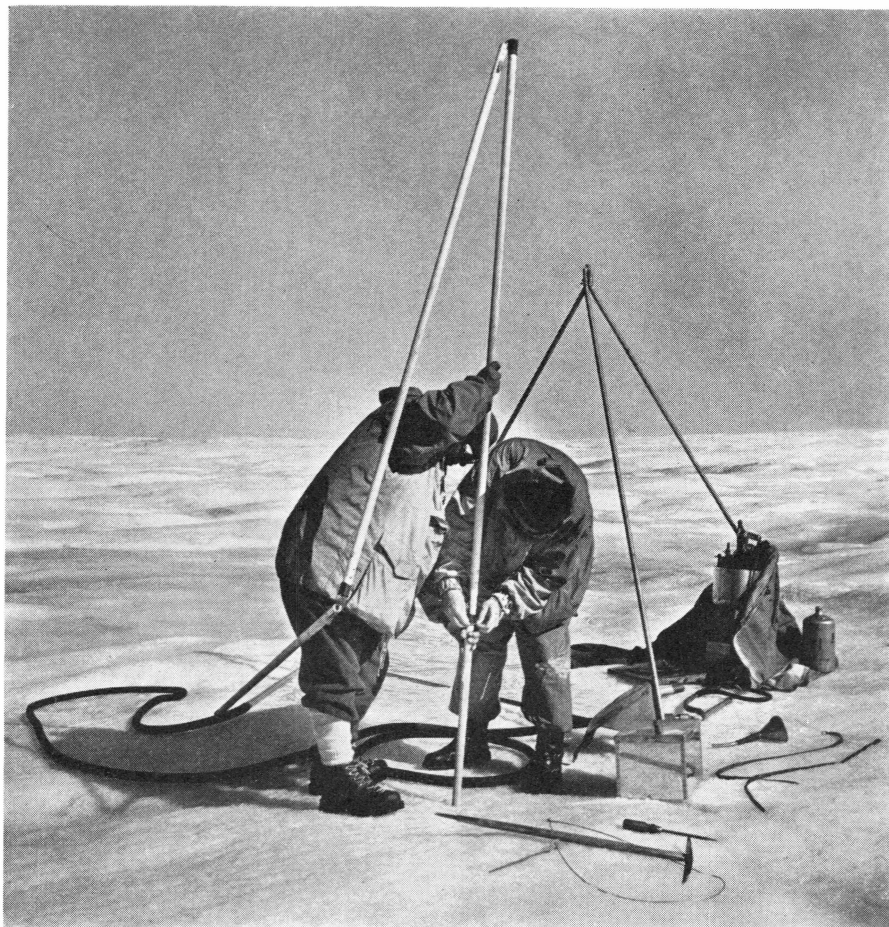
Fig. 15. Einsetzen eines Ablationsgestänge — Verbindung zweier Elemente mit Gummihülle.
