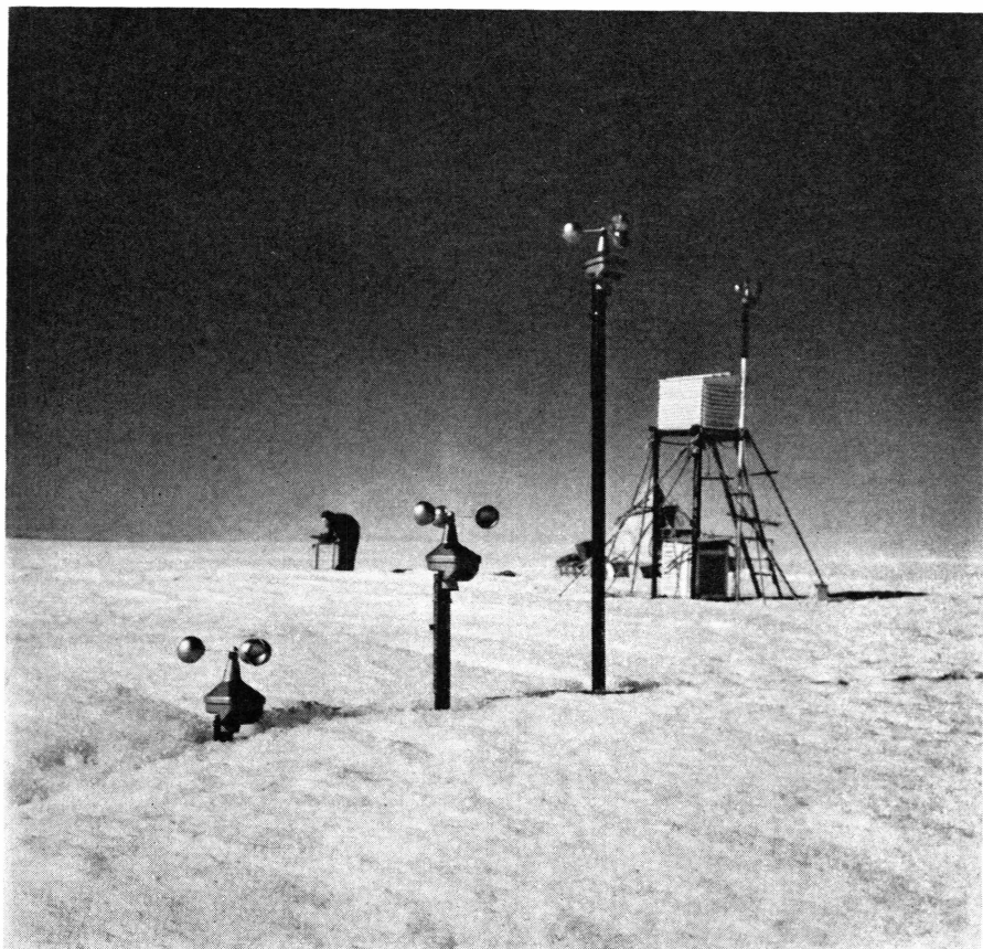
Photo 2. Station météorologique pour l'étude du bilan thermique.
