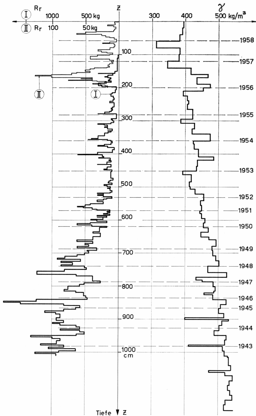
Abb. 27. Profilaufnahme Dépôt 420. 3./4.7.1959. Leichtes und schweres Rammprofil, Dichteprofil (nach Kernbohrung). Versuch einer Schichtdatierung.
