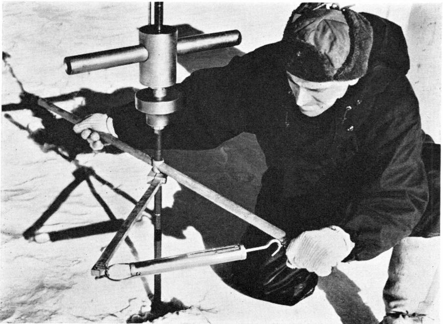
Bild. 1. Messung des Drehwiderstandes (Scherfestigkeit). Drehbarer Hebelarm mit Federwaage.
