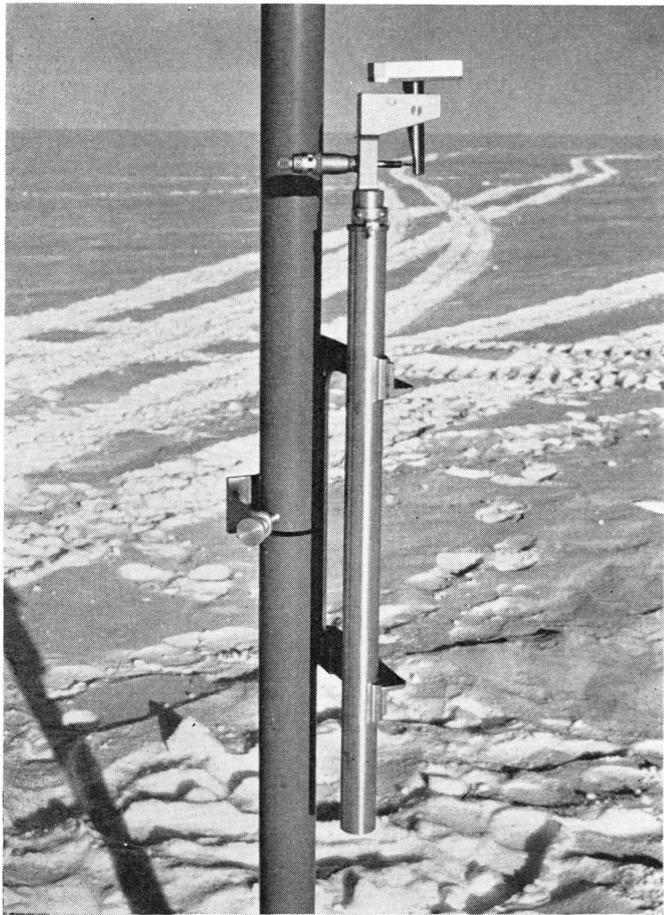
Bild 6. Klinometer in Messtellung an Balise im West-Ost-Profil.
