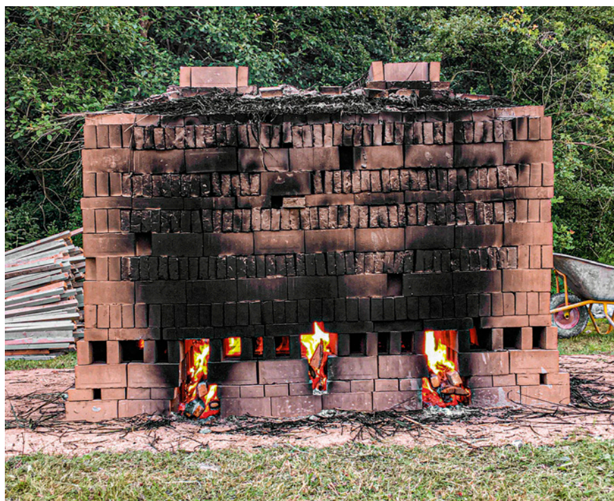
Fig. 14. Milen på Cathrinesminde Teglværk ved Flensborg er færdigopbygget, og brændingen er begyndt. Der fyres med træ. Milen har fået en let afdækning opadtil og er forsynet med et par interimistiske, lave skorstene. Bemærk, at siderne på milen ikke på nogen måde er dækkede. Den forsigtige opvarmning, den egentlige brænding og efterfølgende afkøling tog samme tid som ved en kammerovn. Efter brændingen blev stenene sorteret i gode, mindre gode og for lidt brændte. Særligt mange af de yderste sten i milen var kun delvist brændte. Ved denne brænding blev det til en tredjedel af hver kvalitet. De to sidste sorteringer kan man tage med i den næste brænding og på den måde få flere velbrændte sten. – Foto: Torben A. Vestergaard.
