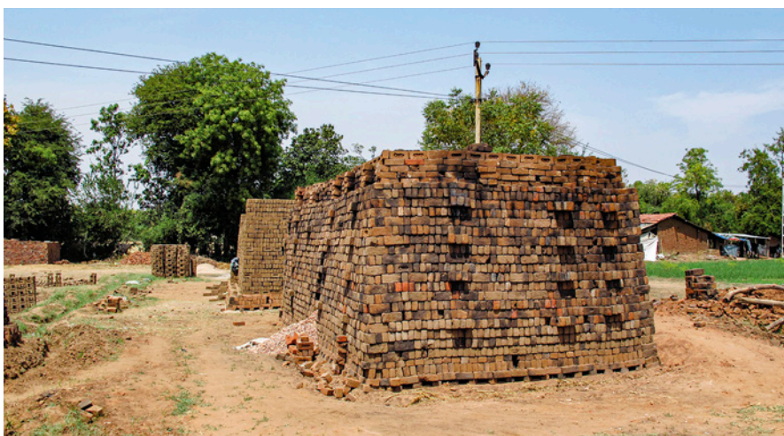
Fig. 15. Miler med tegl. Den forreste mile er brændt og står til afkøling, den bagerste er klar til at blive tændt. Sådanne teglværker, hvor der bruges milebrænding, var det stadig ganske almindeligt at træffe i Indien for et årti eller to siden. Milerne her ligger vest for byen Ahmedabad i delstaten Gujarat, Indien. – Foto: Jan Kock, 2015.
