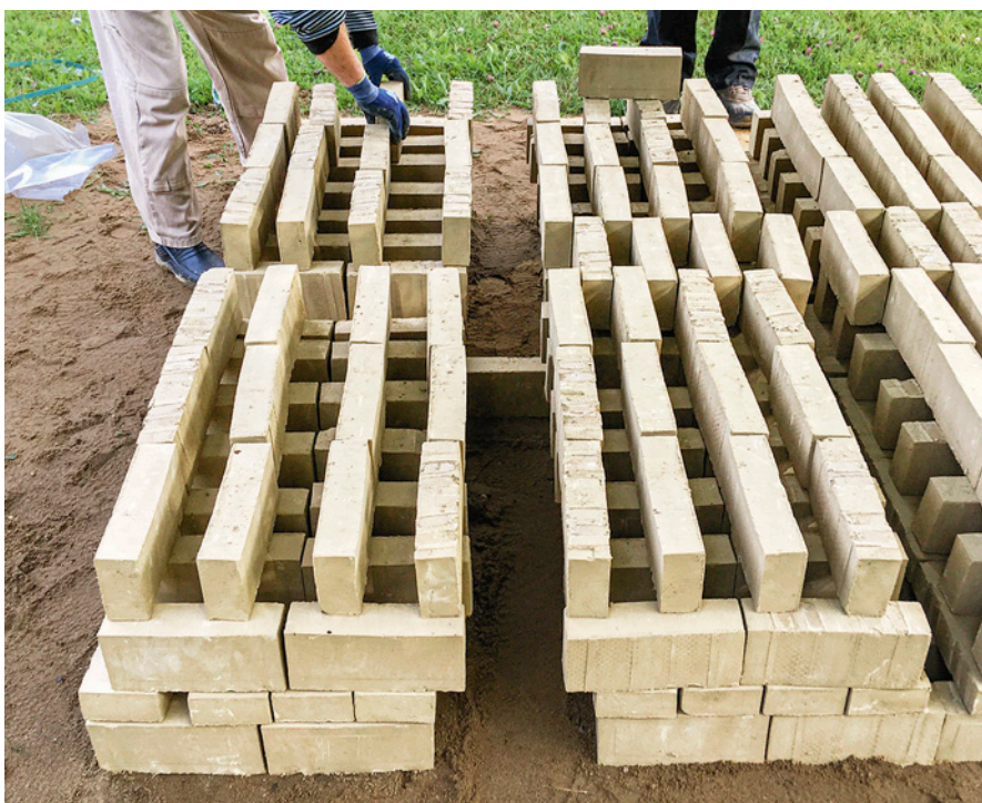
Fig. 13. Forsøg med brænding af tegl i mileovn på museet Cathrinesminde Teglværk ved Flensborg, juli 2017. Man er i gang med at stable de rå sten på en måde, så der dannes fyrkanaler og godt træk mellem alle sten. Ud over museets personale og frivillige deltog Holger Bönisch fra Beilrode i Sachsen, Tyskland, der er ekspert i at brænde tegl i miler. – Foto: Torben A. Vestergaard.
