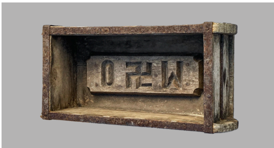
Fig. 16. Teglform fra Indien med teglværkets initialer på bundpladen, måler indvendigt 24,9x12 cm og 1x7,5 cm. Svastikaen er et gedigent hindusymbol. I mange egne af Indien har man brugt forme med bund i modsætning til typen uden bund, der har været gængse at anvende herhjemme, hvor formen egentlig kun er en ramme. – Foto: Jan Kock, 2015.
