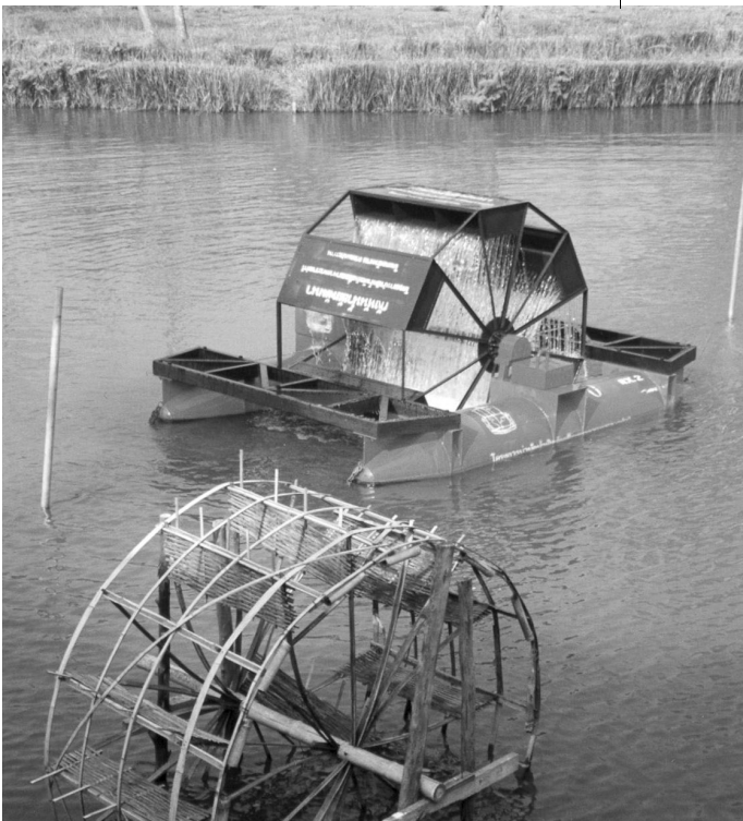
Chaipattana Aerator Model RX-2. Kongens patenterede opfindelse til forøgelse af iltning og reduktion af forurening i vand.
