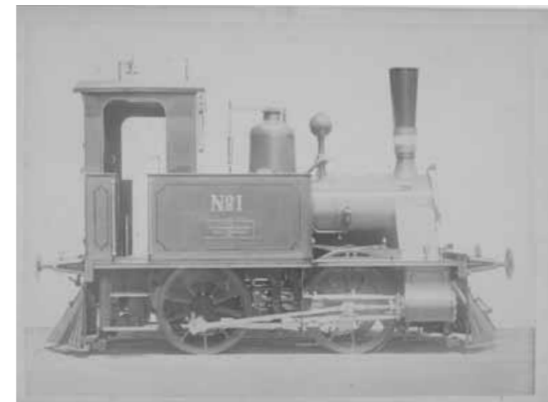
Fabrikfoto af banens første lokomotiv, NFJ 1, leveret af lokomotivfabrikken Esslingen. Der blev fra starten anskaffet to af denne type, der hørte til de mindste i Danmark (Danmarks Jernbanemuseum).
