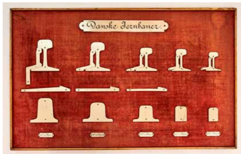
Denne tavle med profiler af skinner, løsker og underlagsplader stammer fra statsbanernes deltagelse i Stockholm i 1897, men den blev også anvendt på Christian IX-udstillingen hos Industriforeningen i København i 1906. Profilerne er ordnet efter vægt, fra højre mod venstre, fra 12 kg/m. til 37 kg/m. (Fl. Wedell fot.).
