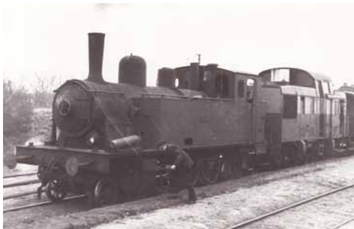
KSB nr. 10. Lokomotivet blev overtaget af DSB i 1. april 1948 som "Nr. 10", men allerede udrangeret i 1950. Modsat sit søsterlokomotiv nr. 9, blev det ikke udstyret med fuldt trykluftudstyr og fik litra B. Nr. 10 var oprindeligt udstyret med vakuumbremser, men den er afmonteret, nok fordi man på fotograferingstidspunktet forventede, at både den og nr. 9 skulle udrangeres til fordel for diesellokomotiverne. Lokomotivet klargøres her til at køre forspand med en større togstamme sammen med diesellokomotivet KSB M1. Men da lokomotivet ikke kunne afbremse togstammen, måtte det køre som forspandslokomotiv. Lokomotivet er fotograferet den 19. februar 1939 på Nørrebro, Lygten station (James Steffensen fot., arkiv Lokomotivet).
