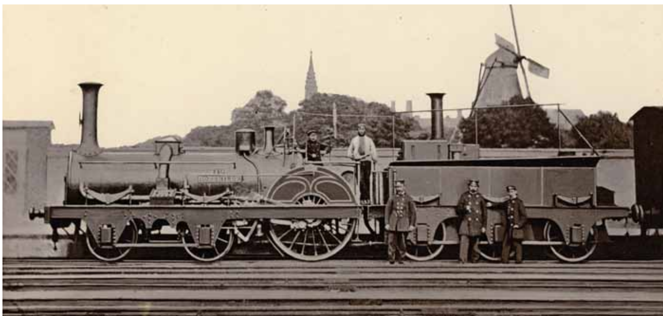
SJS nr. 12 bar navnet Roeskilde og er her fotograferet mellem 1861 og 1867. De såkaldte crampton-lokomotiver efter konstruktøren Th. Crampton (1816-1888) havde kun ét ganske stort drivhjul. Lokomotiverne var derfor ikke egnede til godstog eller tog, der hyppigt gjorde holdt. Det var de sidste lokomotiver med kun ét drivhjul på de danske hovedspor (Danmarks Jernbanemuseum).
