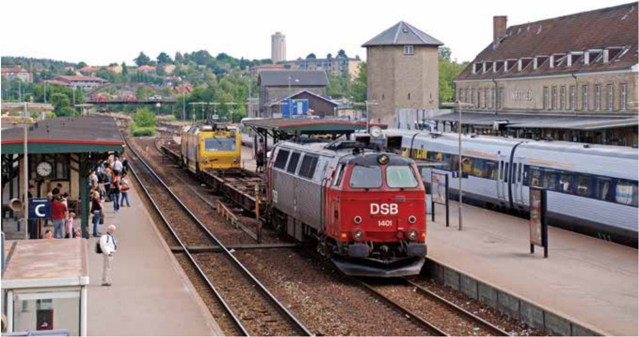
Et målevognstog holder klar i Næstved for at registrere sporets tilstand på banen mod Ringsted i juni 2008. På perronen venter rejsende på regionaltoget mod København (foto: forfatteren).
