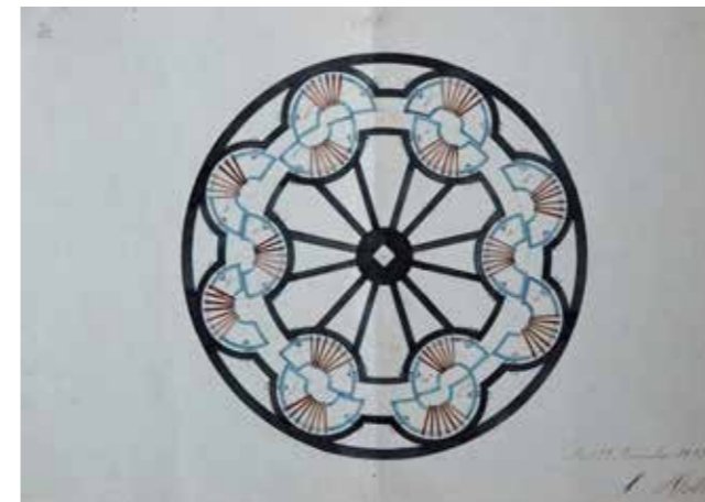
Fig. 13. Tegning nr. 2 til en elektromagnetisk maskine, dateret af Søren Hjorth 23/11 1842 og indsendt til Videnskabernes Selskab for deponering i Selskabets arkiv 27/12 1843.
