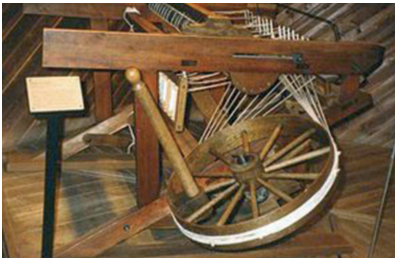
Spindemaskine: Model af tidlig spindemaskine, den såkaldte "Spinning Jenny". Maglekildes spindemaskiner kan have lignet denne model. Museum für Frühindustrialisierung i Wuppertal
