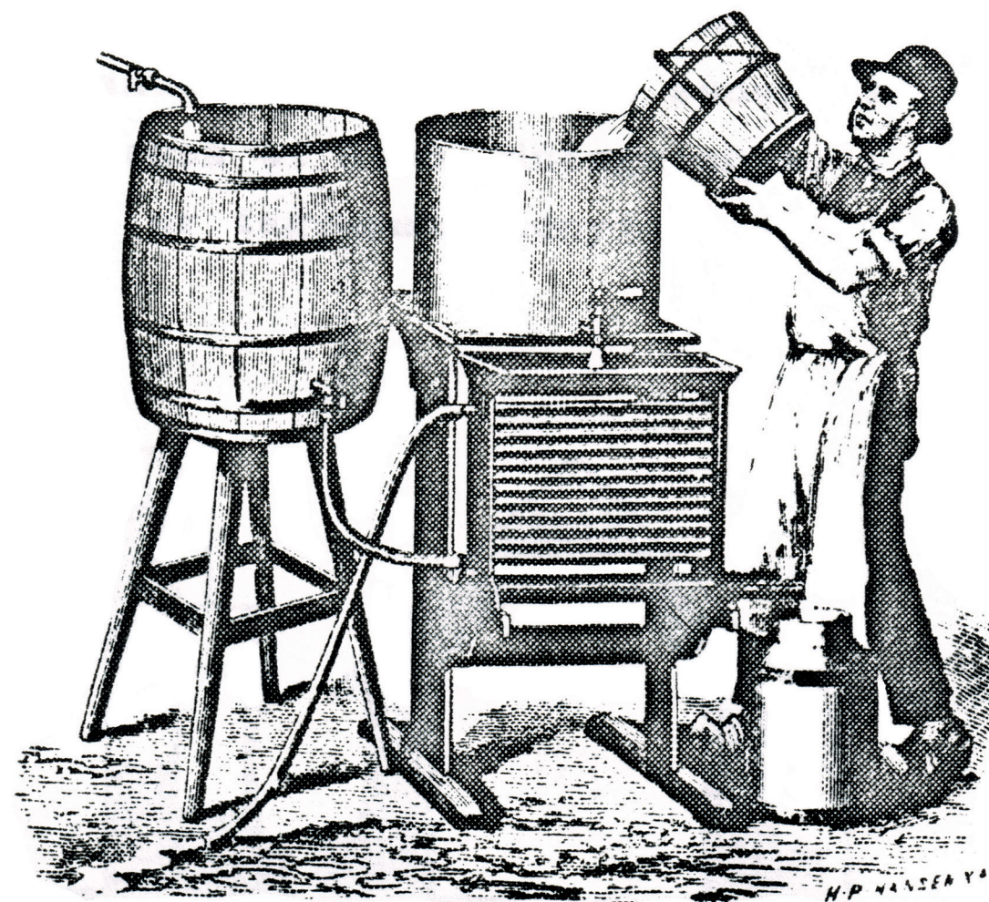
I bestræbelserne på en øget ensartethed og kvalitet i herregårdenes mejeriprodukter udvikledes et væld af teknikker og redskaber. Her en overrislingskøler til anvendelse i herregårdenes ismejerier. Isen anbringes i tønden til venstre. Illustration: Bøgild, B. 1896.
