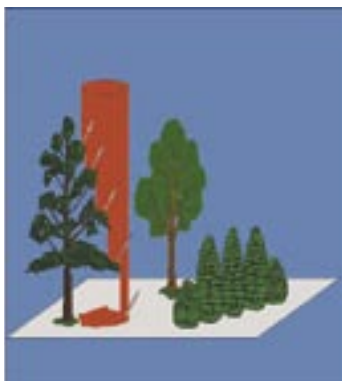
Figur 4: En laserstråle rammer et træ. Dele af strålen reflekteres fra de forskellige niveauer i træet og fra terrænet.
